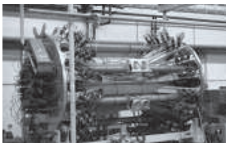
Le Détecteur à grande acceptation pour la physique photonucléaire expérimentale (DAPHNE), au Microtron de Mainz, en Allemagne, où des physiciens canadiens étudient la photoproduction des résonances nucléaires.
