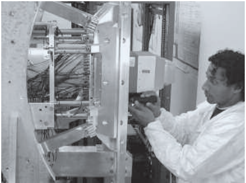
Installation du premier détecteur de rayons gamma du nouveau spectromètre TIGRESS, mis au point pour l'installation d'ions radioactifs accélérés ISAC-II.
