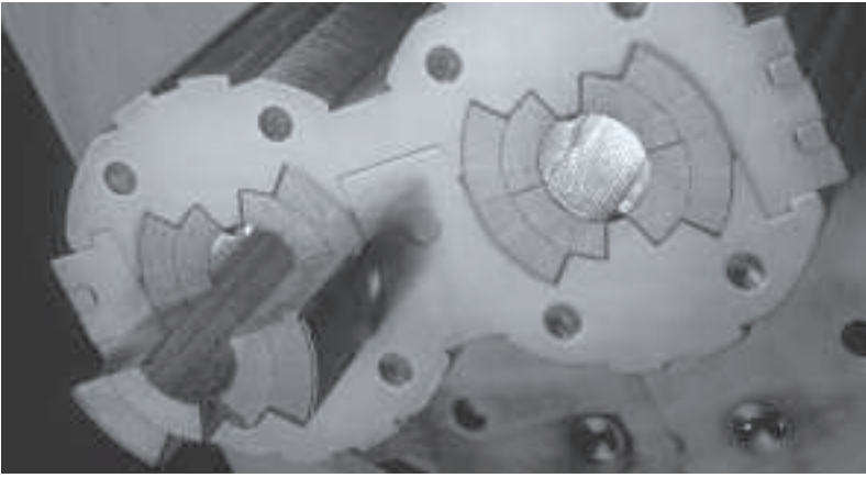
Cœur d'un aimant dipolaire supraconducteur du LHC. On voit clairement les deux chambres dans lesquelles les deux faisceaux de protons circulent.
