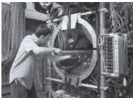
Insertion d'une source dans le détecteur Crystal Ball, afin de procéder à un étalonnage énergétique. Le détecteur Crystal Ball est utilisé à Mainz (Allemagne) par une collaboration de physiciens, dont certains proviennent de la Mount Allison University.
